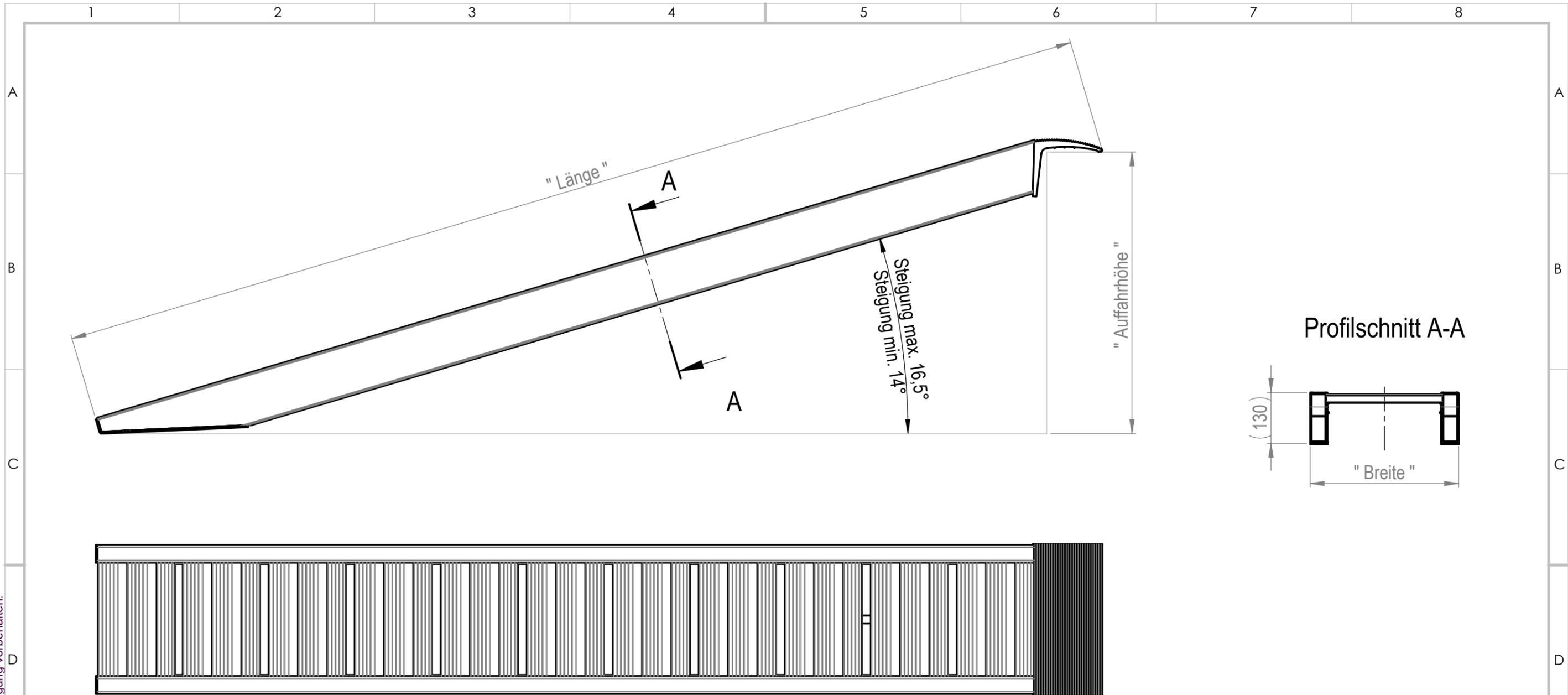
\*Die Tragkraftangaben gelten pro Paar und beziehen sich auf ein zweiachsiges Fahrzeug mit einem Achsabstand von 1500 mm und einer gleichmässigen Lastverteilung (50% zu 50%).
